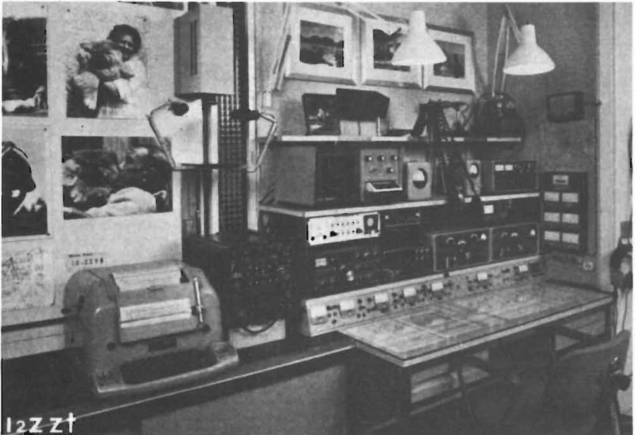
Fig. 5 - Stazione d'amatore classica equipaggiata con RTTY «Versione meccanica». Manipolazione tramite AFSK in HF e VHF.
